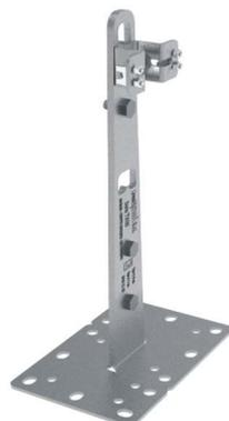
Ancoraggio Intermedio di tipo C in acciaio INOX AISI 304, h 30/50 cm su BASE PIANA dotato di blocco fune per ridurre la freccia sulla linea vita in caso di caduta e ottimizzare la distribuzione dei carichi sugli ancoraggi della campata. Dalla confezione sono esclusi gli elementi per i fissaggi alla struttura.
