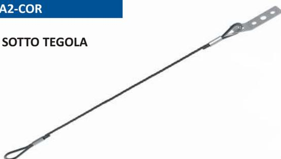
Cordino Sotto Coppo - Sotto Tegola con fune Inox  $\varnothing$  8 + Piastra di Fissaggio in acciaio INOX AISI 304/316, di tipo A, lunghezza utile cm 70.
