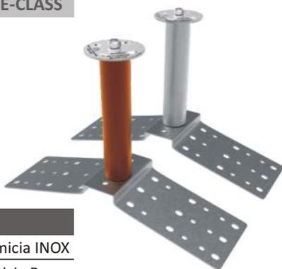
Ancoraggio Terminale di tipo C in acciaio INOX AISI 304 e camicia in INOX / Rame. h 35 cm, su PIASTRA PER COLMO maggiorata per MURICCI E TAVELLONI. Se correttamente fissato l'ancoraggio può supportare l'azione esercitata da Linee Vita per campate fino a 15 m. L'ancoraggio può essere utilizzato anche come ancoraggio di tipo A. Dalla confezione sono esclusi gli elementi per i fissaggi alla struttura.
