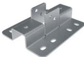
Supporto in acciaio INOX AISI 304 dotato di ali per il necessario collegamento ai pali della serie PQS. Il collegamento piastra-palo avviene mediante viti e dadi M16 comprese nella confezione dei pali. Dalla confezione sono escluse le barre per i fissaggi alla struttura.
