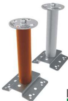
Ancoraggio Terminale di tipo C in acciaio INOX AISI 304 e camicia in INOX / Rame. h 35 cm su PIASTRA RIALZATA A BASE PIANA/PER COLMO. Se correttamente fissato l'ancoraggio può supportare l'azione esercitata da Linee Vita per campate fino a 15 m. L'ancoraggio può essere utilizzato anche come ancoraggio di tipo A. Dalla confezione sono esclusi gli elementi per i fissaggi alla struttura.
