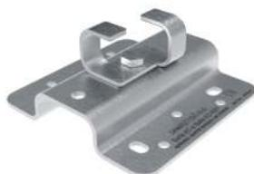
Ancoraggio strutturale, intermedio in acciaio INOX AISI 304. L'ancoraggio è dotato di dispositivo passapalo che consente di superarlo senza sganciare il moschettone del DPI, inoltre riduce la freccia sulla Linea Vita in caso di caduta. Distanza fune al piano di appoggio dell'ancoraggio cm 9 ca. L'ancoraggio è abbinabile ad un ancoraggio con riduttore di tensione (es.: PQS-35D / AC-OD). Dalla confezione sono esclusi gli elementi per i fissaggi alla struttura.
