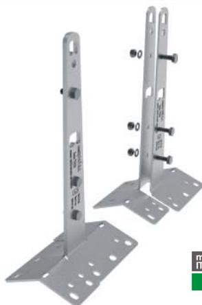
Ancoraggio Terminale di tipo C in acciaio INOX AISI 304, h 30/50 cm su BASE PER COLMO. Se correttamente fissato l'ancoraggio può supportare l'azione esercitata da Linee Vita per campate fino a 15 m. L'ancoraggio può essere utilizzato anche come ancoraggio di tipo A. Dalla confezione sono esclusi gli elementi per i fissaggi alla struttura.
