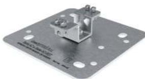
Ancoraggio strutturale, intermedio, in acciaio INOX AISI 304, dotato di blocco fune per ridurre la freccia sulla Linea Vita in caso di caduta e ottimizzare la distribuzione dei carichi sugli ancoraggi della campata.
