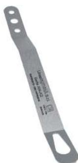
Ancoraggio strutturale in acciaio INOX AISI 304, di tipo A idoneo per coperture con tegole o coppi a basso spessore. L'ancoraggio è predisposto per fissaggi con barre filettate o viti. La tipologia e il numero dei fissaggi sono in funzione del supporto della struttura.
