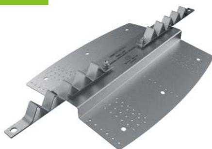
Ancoraggio Terminale PER COLMO di tipo C in acciaio INOX AISI 304 per coperture in lamiera, compresa doppia molla di assorbimento. Se correttamente fissato l'ancoraggio può supportare l'azione esercitata da Linee Vita per campate fino a 10 m. La confezione comprende i rivetti con guarnizione necessari per il fissaggio e il biadesivo in schiuma acrilica.
