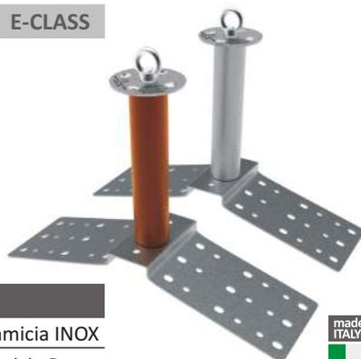
Ancoraggio Terminale/Intermedio con Golfare di tipo C in acciaio INOX AISI 304 e camicia in INOX / Rame. h 35 cm, su PIASTRA PER COLMO maggiorata per MURICCI E TAVELLONI. Dalla confezione sono esclusi gli elementi per i fissaggi alla struttura.
