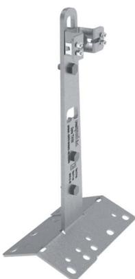
Ancoraggio Intermedio di tipo C in acciaio INOX AISI 304, h 30/50 cm su BASE PER COLMO dotato di blocco fune per ridurre la freccia sulla linea vita in caso di caduta e ottimizzare la distribuzione dei carichi sugli ancoraggi della campata. Dalla confezione sono esclusi gli elementi per i fissaggi alla struttura.
