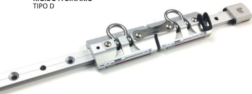
Certificazione UNI EN 795:2012, certificazione CEN/TS 16415 per 2 operatori, 2 possibili utilizzi: Linea Vita o Sospensione Umana. In alluminio anodizzato T6 6061 ad alta resistenza alla corrosione, dimensioni contenute: sezione del binario 14 mm x 27 mm, carrello a ricircolo di sfere in Torlon, montaggio in qualunque posizione (pavimento, parete, soffitto), fissaggio in aderenza alla superficie di posa.
