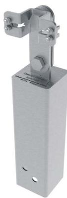
Palo in acciaio INOX AISI 304 dotato di dispositivo che riduce la tensione sulla struttura in caso di caduta, dotato inoltre di blocco fune per ridurre la freccia sulla Linea Vita e ottimizzare la distribuzione di carichi sugli ancoraggi della campata.
