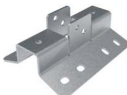
Supporto in acciaio INOX AISI 304, appositamente piegato per il posizionamento diretto sulla trave di colmo, dotato di ali per il necessario collegamento ai pali della serie PQS. Il collegamento piastra-palo avviene mediante viti e dadi M16 comprese nella confezione dei pali. Dalla confezione sono escluse le barre per i fissaggi alla struttura.
