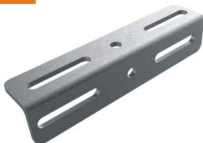
Contropiastra in acciaio INOX AISI 304 con interasse fori da 13 a 28 cm. La contropiastra è piegata ad L e permette anche diverse tipologie di raccordi in più direzioni (es.: raccordo tra fissaggi a parete e fissaggi piani). Dalla confezione sono escluse le barre per il collegamento alla piastra.
