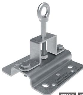
Ancoraggio strutturale Terminale/Intermedio di tipo C in acciaio INOX AISI 304. Distanza fune al piano di appoggio dell'ancoraggio 25 cm ca. Se correttamente fissato, l'ancoraggio può supportare l'azione esercitata da Linee Vita per campate fino a 15 m. Dalla confezione sono esclusi gli elementi per i fissaggi alla struttura.
