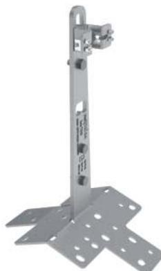
Ancoraggio Intermedio di tipo C in acciaio INOX AISI 304, h 30/50 cm su BASE INCLINATA PER TRAVETTI, dotato di blocco fune per ridurre la freccia sulla linea vita in caso di caduta e ottimizzare la distribuzione dei carichi sugli ancoraggi della campata. Dalla confezione sono esclusi gli elementi per i fissaggi alla struttura.
