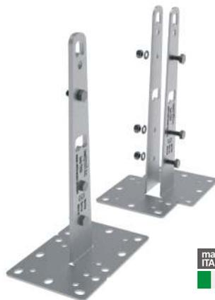
Ancoraggio Terminale di tipo C in acciaio INOX AISI 304, h 30/50 cm su BASE PIANA. Se correttamente fissato l'ancoraggio può supportare l'azione esercitata da Linee Vita per campate fino a 15 m. L'ancoraggio può essere utilizzato anche come ancoraggio di tipo A. Dalla confezione sono esclusi gli elementi per i fissaggi alla struttura.
