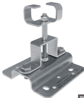
Ancoraggio strutturale Intermedio di tipo C in acciaio INOX AISI 304 dotato di dispositivo passapalo che consente di superarlo senza sganciare il moschettone del DPI. Inoltre riduce la freccia sulla Linea Vita in caso di caduta. Distanza fune al piano di appoggio dell'ancoraggio 25 cm ca. Dalla confezione sono esclusi gli elementi per i fissaggi alla struttura.
