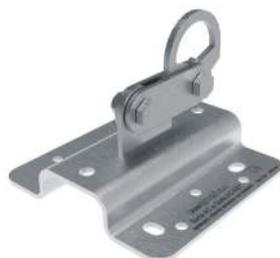
Ancoraggio strutturale, terminale, in acciaio INOX AISI 304, dotato di dispositivo che riduce la tensione sulla struttura in caso di caduta. Distanza fune al piano di appoggio dell'ancoraggio cm 9 ca. Se correttamente fissato, l'ancoraggio può supportare l'azione esercitata da Linee Vita per campate fino a 20 m. Dalla confezione sono esclusi gli elementi per i fissaggi alla struttura.
