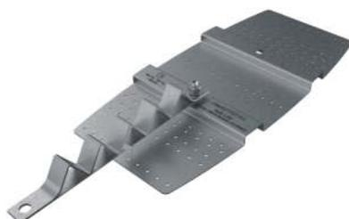
Ancoraggio Terminale PIANO di tipo C in acciaio INOX AISI 304 per coperture in lamiera, compresa molla di assorbimento. Se correttamente fissato l'ancoraggio può supportare l'azione esercitata da Linee Vita per campate fino a 10 m. La confezione comprende i rivetti con guarnizione necessari per il fissaggio e il biadesivo in schiuma acrilica.
