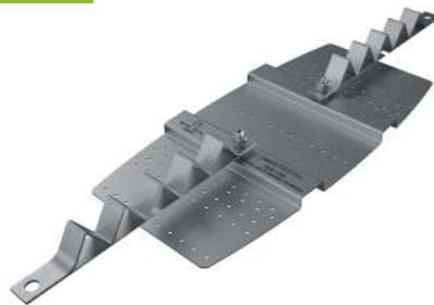
Ancoraggio Terminale PIANO di tipo C in acciaio INOX AISI 304 per coperture in lamiera, compresa doppia molla di assorbimento. Se correttamente fissato l'ancoraggio può supportare l'azione esercitata da Linee Vita per campate fino a 10 m. La confezione comprende i rivetti con guarnizione necessari per il fissaggio e il biadesivo in schiuma acrilica.
