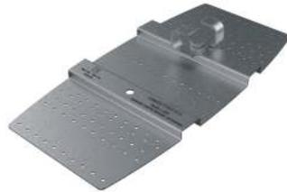
Ancoraggio Intermedio PIANO di tipo C in acciaio INOX AISI 304 per coperture in lamiera, senza molla di assorbimento, con Passapalo. La confezione comprende i rivetti con guarnizione necessari per il fissaggio e il biadesivo in schiuma acrilica.
