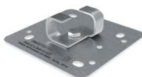
Ancoraggio strutturale, intermedio, in acciaio INOX AISI 304. l'ancoraggio è dotato di dispositivo passapalo che consente di superarlo senza sganciare il moschettone del DPI, inoltre riduce la freccia sulla Linea Vita in caso di caduta.
