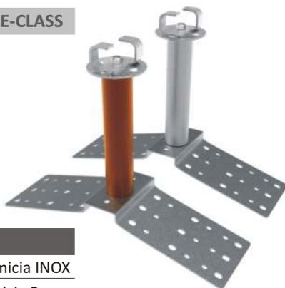
Ancoraggio Intermedio per Funne Passante di tipo C in acciaio INOX AISI 304 e camicia in INOX / Rame. h 35 cm, su PIASTRA PER COLMO maggiorata per MURICCI E TAVELLONI. Dalla confezione sono esclusi gli elementi per i fissaggi alla struttura.
