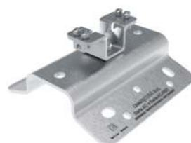
Ancoraggio strutturale, intermedio, in acciaio INOX AISI 304. L'ancoraggio è dotato di blocco fune per ridurre la freccia sulla Linea Vita in caso di caduta e ottimizzare la distribuzione dei carichi sugli ancoraggi della campata.
