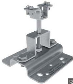
Ancoraggio strutturale Intermedio di tipo C in acciaio INOX AISI 304 dotato di blocco fune per ridurre la freccia sulla Linea Vita in caso di caduta ed ottimizzare la distribuzione dei carichi sugli ancoraggi della campata. Distanza fune al piano di appoggio dell'ancoraggio 25 cm ca. Dalla confezione sono esclusi gli elementi per i fissaggi alla struttura.
