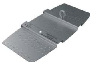
Ancoraggio Intermedio PIANO di tipo C in acciaio INOX AISI 304 per coperture in lamiera, senza molla di assorbimento, con Golfare. La confezione comprende i rivetti con guarnizione necessari per il fissaggio e il biadesivo in schiuma acrilica.
