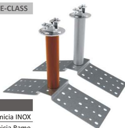
Ancoraggio Intermedio con Blocco Funne di tipo C in acciaio INOX AISI 304 e camicia in INOX / Rame. h 35 cm, su PIASTRA PER COLMO maggiorata per MURICCI E TAVELLONI. Dalla confezione sono esclusi gli elementi per i fissaggi alla struttura.
