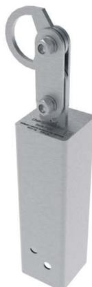
Palo in acciaio INOX AISI 304 dotato di dispositivo che riduce la tensione sulla struttura in caso di caduta. Il palo deve essere montato su piastra piana (S-PL) o su piastra per colmo (S-CL). Il collegamento piastra-palo avviene mediante viti e dadi M16 comprese nella confezione. Se correttamente montato, il palo può sopportare l'azione esercitata da Linee Vita per campate fino a 20 m.
