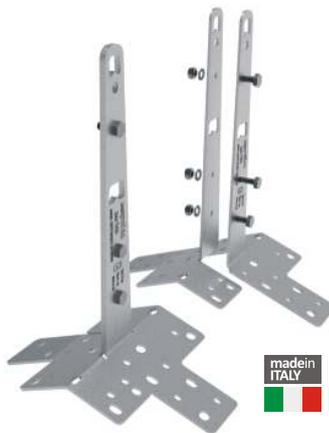
Ancoraggio Terminale di tipo C in acciaio INOX AISI 304, h 30/50 cm su BASE INCLINATA PER TRAVETTI. Se correttamente fissato l'ancoraggio può supportare l'azione esercitata da Linee Vita per campate fino a 15 m. L'ancoraggio può essere utilizzato anche come ancoraggio di tipo A. Dalla confezione sono esclusi gli elementi per i fissaggi alla struttura.
