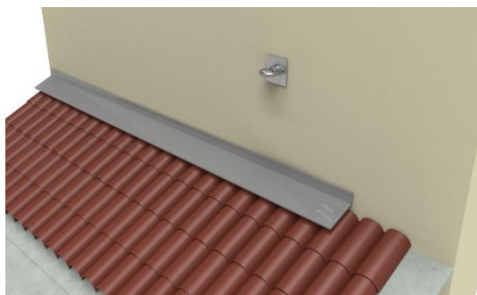
Fissaggio con barra filettata a muro
