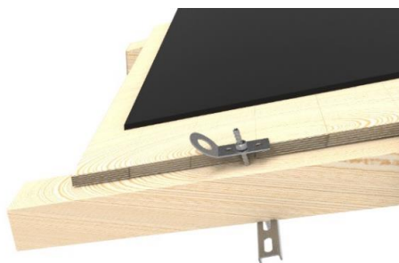
A-ZERO: Fissaggio con barra filettata passante e contropiastra
